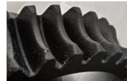
Рис. 4 – Фрагмент черв'ячного колеса отриманий 3D друком
