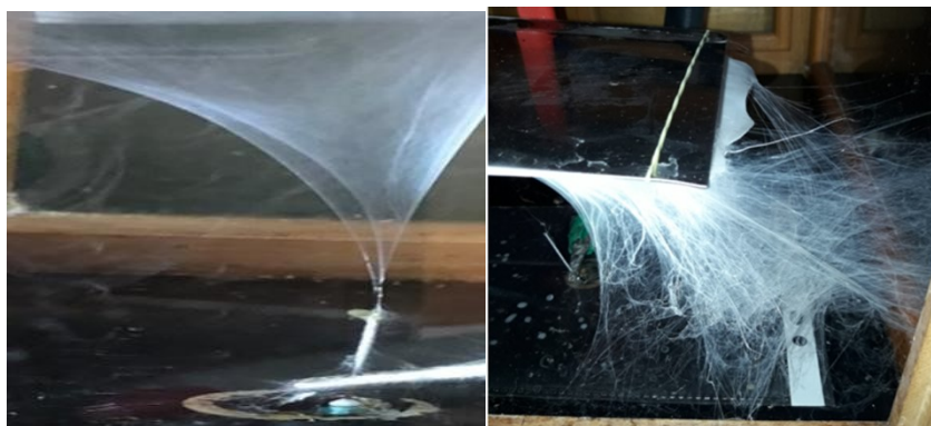
Рис.1. Процес розщеплення розчину з капіляру на мікрОВОлокна та утворення зразків нетканого матеріалу
