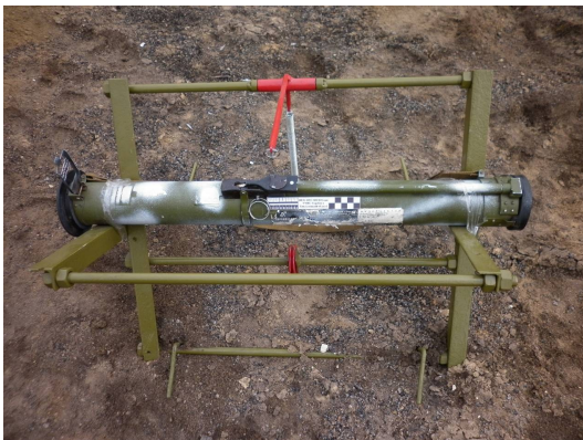
Рис.2. Світлина пристрою для дистанційного приведення в дію реактивних гранатометів (головний вид)
