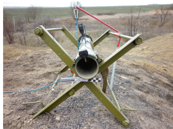
Рис.3. Світлина пристрою для дистанційного приведення в дію реактивних гранатометів (вид по осі пострілу)
